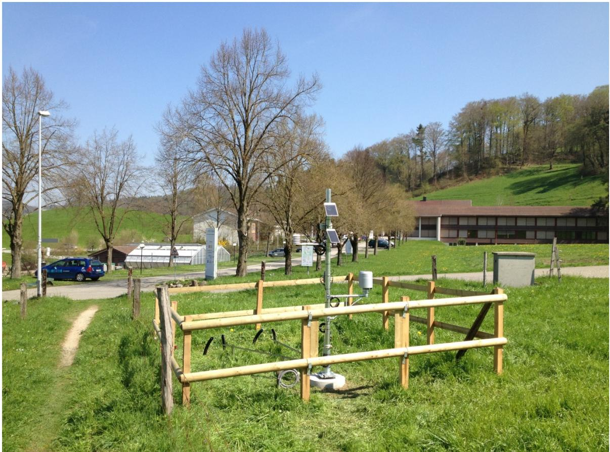
**In jeder Aluminiumschiene verlaufen die Kabel eines Tensiometers in 20 und 35 cm Bodentiefe. Die Tensiometer selber sind durch schwarze Plastikrohre gegen äussere Einflüsse geschützt.**
