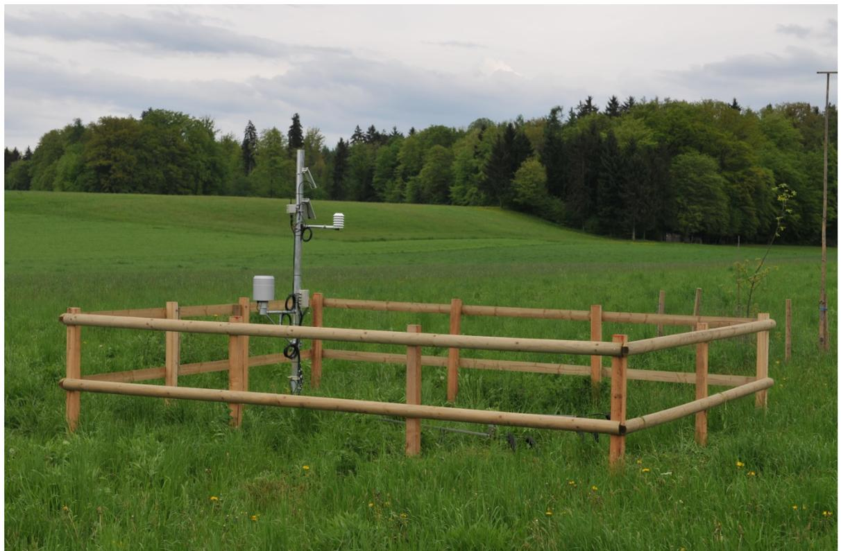
**Mast mit den oberirdischen Messgeräten, den Solarpanels sowie den Instrumenten für die Datenspeicherung und Datenübermittlung.**
