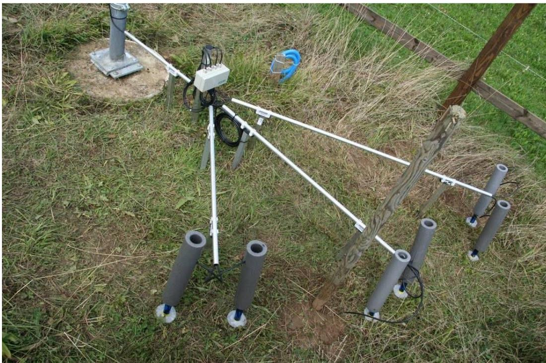
*Fertig installierte Tensiometer mit Schutzhülle*
